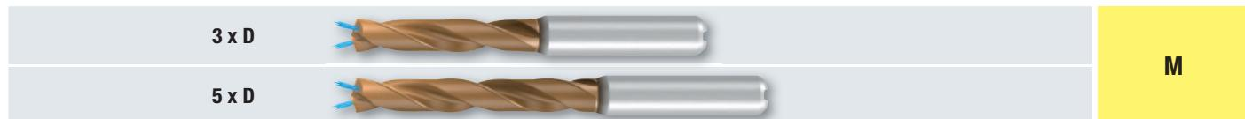
Speziell für die Zerspanung von austenitischen, rostfreien Stählen ausgelegt, sind diese Spiralbohrer in den Ausführungen nach DIN 6537 kurz (3 x D) und lang (5 x D) erhältlich. Sie können aber ebenso in Spezialwerkstoffen wie Titan-Legierungen, Nickel-Legierungen, Kobalt-Legierungen und Eisen-Legierungen eingesetzt werden.
